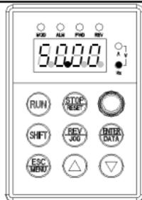
Fig.c Run status, display run status parameter
